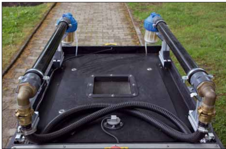
Zentrale Einfüllöffnung des Wassertanks
