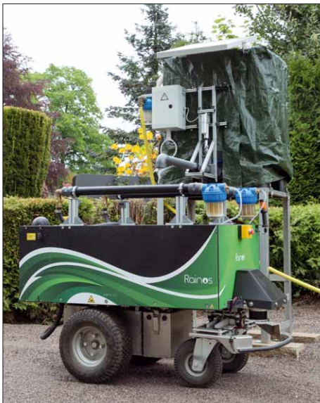
Der Rainos fährt autonom zentral unter den Auslauf der solarbetriebenen Tankstation
