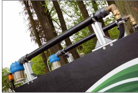
Die beiden Rohre besitzen feine, seitliche Düsen für 60 cm Spritzbreite
