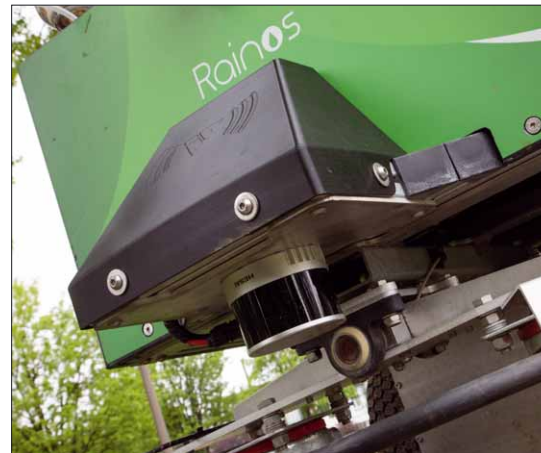
Der Lidar-Sensor erkennt Hindernisse zuverlässig
