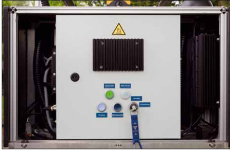
Mit dem Schlüssel wird zwischen Automatik- und Fernbedienungsmodus gewechselt
