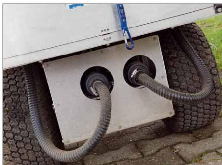
Der Rainos ist nach IP65 gegen Staub und Wasser geschützt
