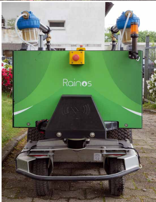
Sensortechnik und Not-Aus an der Front
