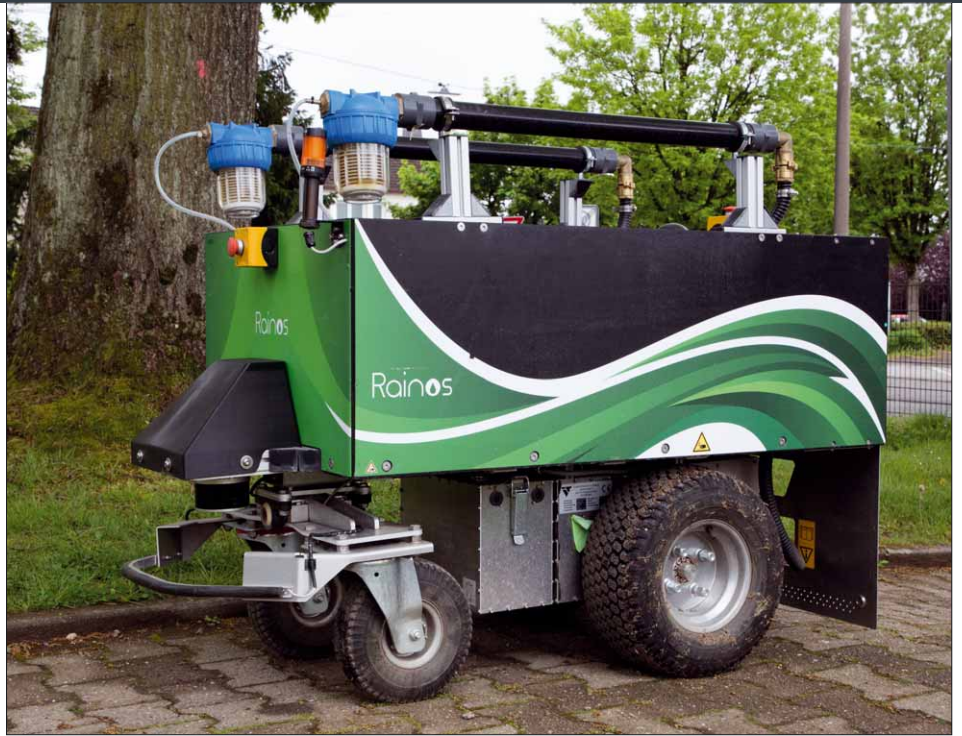
Die 41cm großen Hinterräder bieten mit ihrem rasenschonenden Turf-Profil guten Grip
